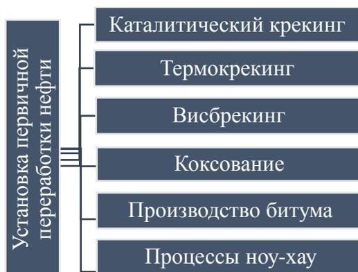
Рисунок 1. Виды применяемых процессов глубокой переработки нефти на НПЗ Узбекистана
